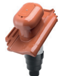
ALU-SYSTEM Sanitarni prezračevalni strešnik DN 125 z odstranljivim pokrovnim vložkom, priključno gibljivo cevjo (70 cm), UD-tesnilno manšeto in reducirnim elementom
